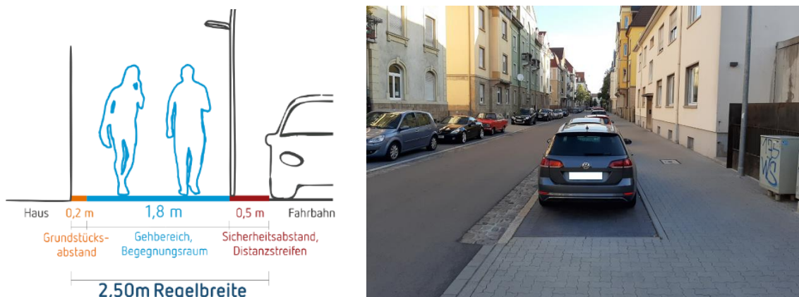
Abbildung 9: Regelbreite nach FGSV (links), Beispiele für eine Mindestgehwegbreite von 2,50 m (rechts)
